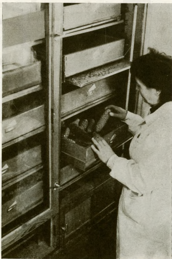
20. ábra. Házi cserényes magpergető szekrény (A szerző felv.)
