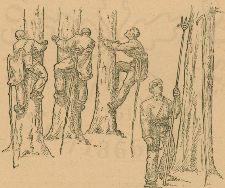
48. ábra. Maggyűjtő felszerelése (tobozvágó szigony, tobozszedő fésű, biztosító-öv, ágbehúzó kampó) és a fáramászás mozdulatai.
