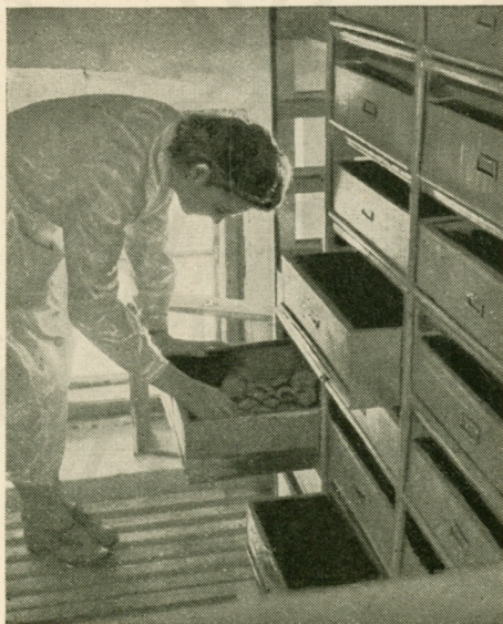
64. ábra. Laboratóriumi cserényfiókos magpergető emeleti része. (A kihozatali vizsgálatokhoz használják.)
