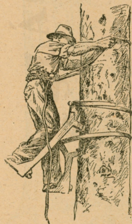
49. ábra. Famászó szerkezetek elit törzsek megmászásához (a törzset nem sértik).
