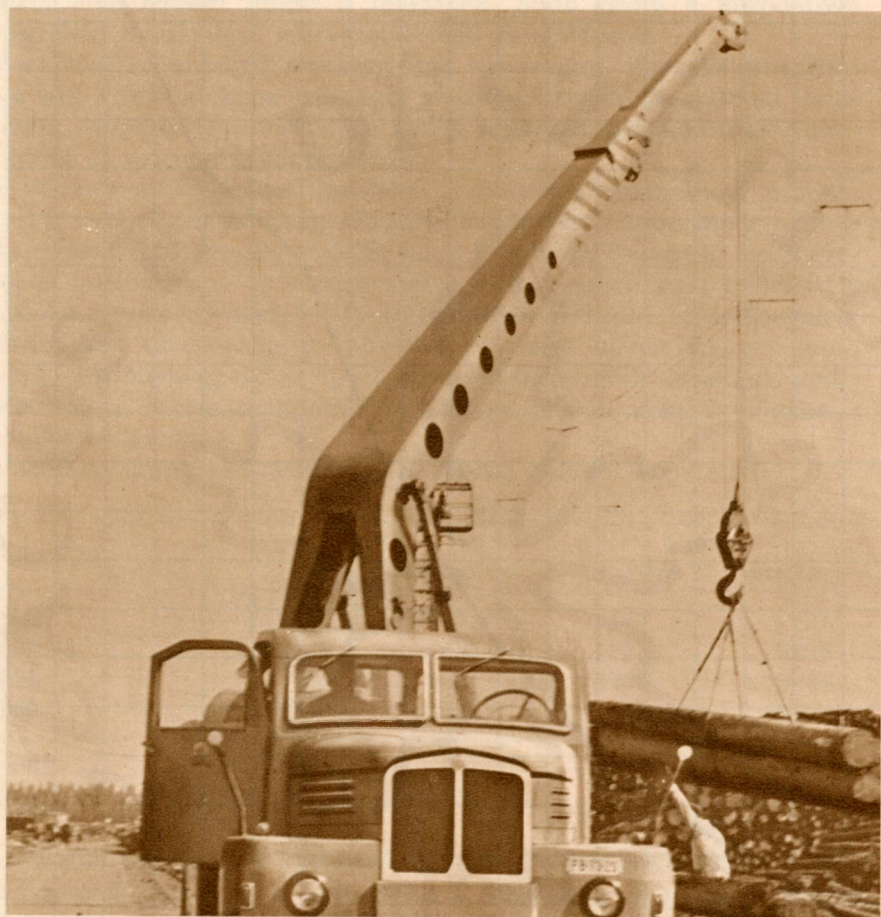
Rönkfelrakás gépkocsira Panther daruval (Szebelédy G. felv.)
