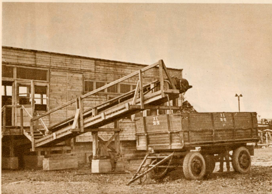
Elevátor szállítja ki a kéregforgácsot az üzemből
