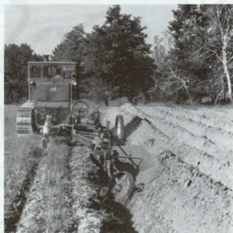
72. A teljes talajelőkészítést PP-50-PG rigol- eke végzi
