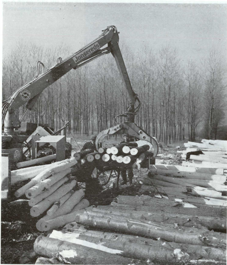
59. Kérgészés korszerű önrakodó kérgezőgéppel
