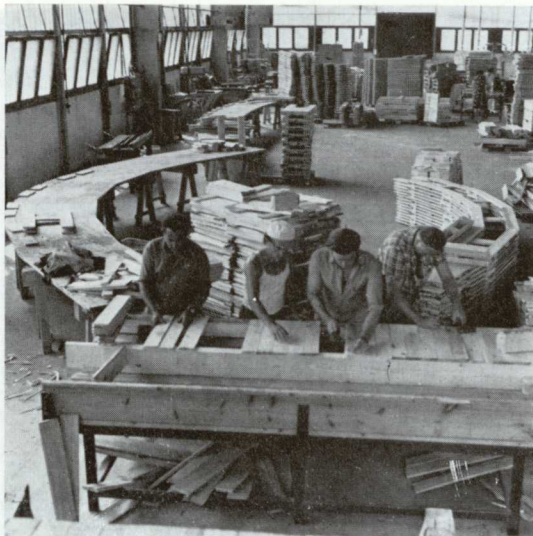
100. Szegeztett fatartógyártás a hajdúhadházi üzemben
