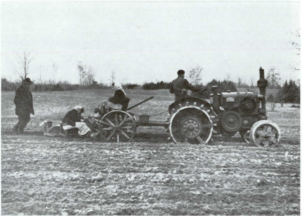
18. Erdőtelepítés csemeteültetőgéppel mezőgazdaságilag nem hasznosítható területen
