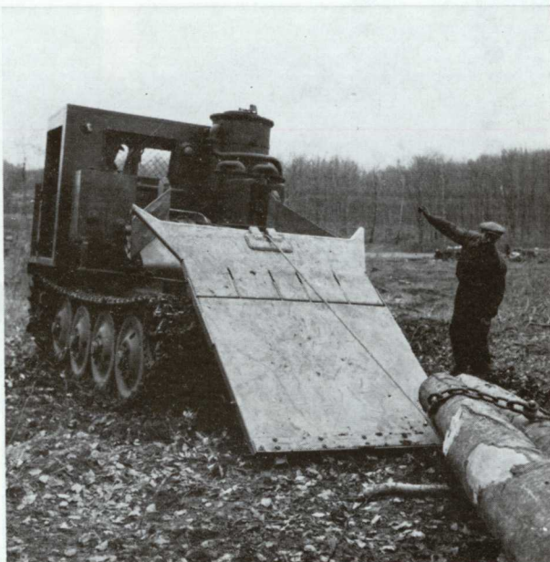
65. Az első speciális közelitő traktorok egyike: a fagágenerátoros szovjet KT-12
