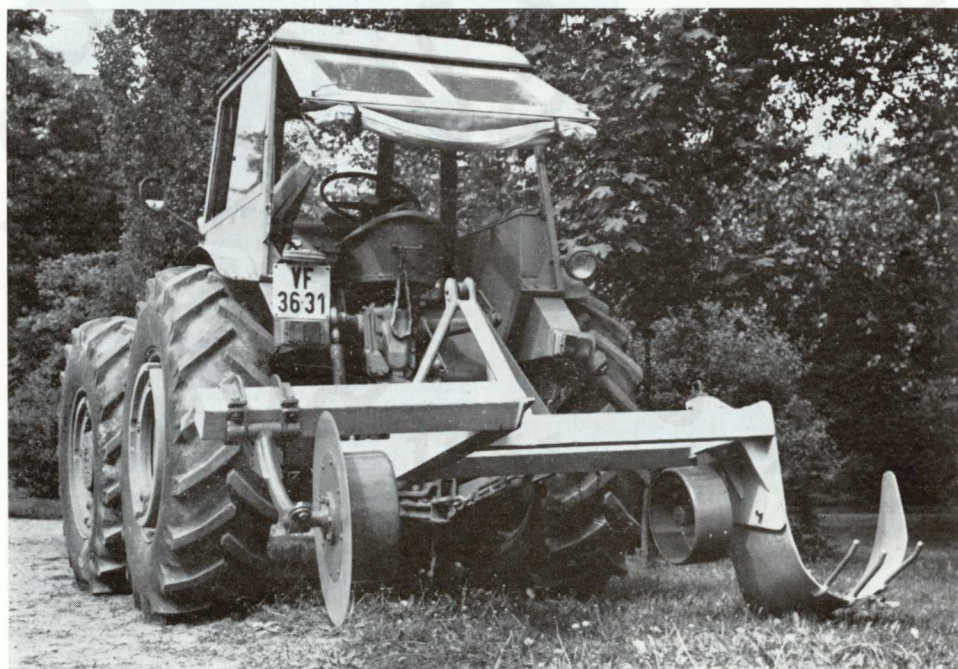
75. A korszerű gördülőtárcsás kiegyensúlyozású ERTI csemetekiemelő
