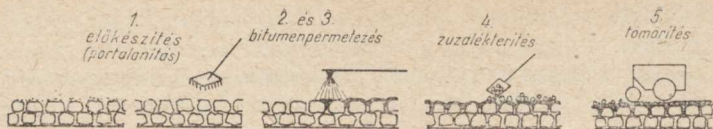
60. ábra. Felületi bevonás munkafolyamata
