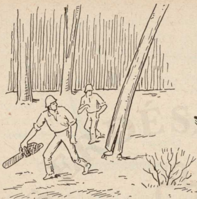
33. ábra. A húzott fa széles törési léccel korán kezd dőlni, ha a döntővágást a húzás irányába vezetjük. Az ilyen fa felszakad, felhasad
