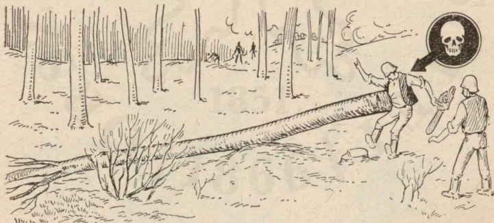
17. ábra. A fa megindulásakor a fa tövétől részsút hátra el kell távolodni. Közben figyelni kell a fa tövét és a lehulló ágakat. Döntés előtt az akadályok elhárításával biztosítani kell a szabad mozgás lehetőségét
