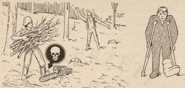
1. ábra. A gázadagolást úgy kell beszabályozni, hogy alapjáratban a lánc ne mozogjon
