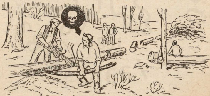
4. ábra. Állandóan gondoljunk arra, hogy a lánc elszakadva előre kivágódhat. Ezért ne hajoljunk a járó lánc fölé és küldjük el a szembenállót
