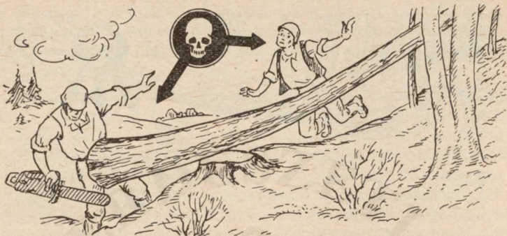
18. ábra. Ha nem hagyunk törési lépcsőt vagy a fát teljesen átfűrészeljük, a fa a tuskón visszacsúszhat és súlyos baleset okozója lehet
