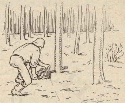
44. ábra. Kb. 15 cm-nél vékonyabb tőátmérőjű fák döntése hátéli párhuzamos vágásból álló hajkvágással és egyszerű párhuzamos vágásból álló döntővágással
