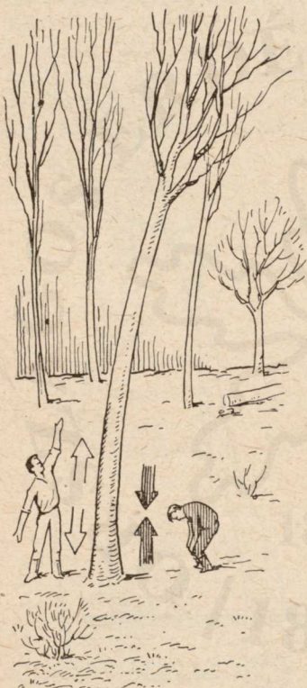
42. ábra. A fa rostjai a kihajlás felőli oldalon nyomottak, az ellentétes oldalon húzottak
