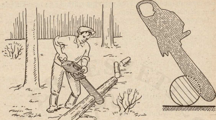
62. ábra. A vezetőlemez hosszának felét el nem érő átmérőjű fa darabolóvágása egyszerű párhuzamosvágással a fa feszültségmentes helyén
