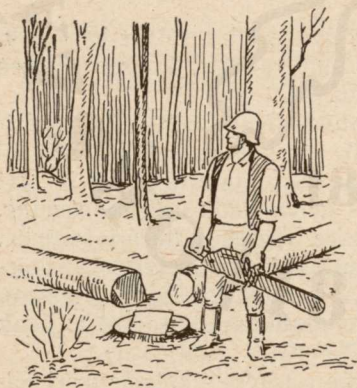
58. ábra. Tőben kétfelé elágazó, ipari célra alkalmas tövű fa döntése alacsony tuskóval
