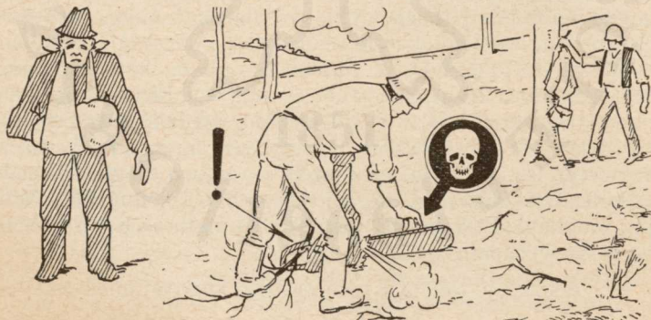
2. ábra. A lánchoz vagy a vezetőlemezhez csak a motor leállítása után szabad hozzányúlni
