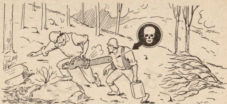
3. ábra. Nehezen járható terepen csak leállított motorral szabad átmenni a következő fához
