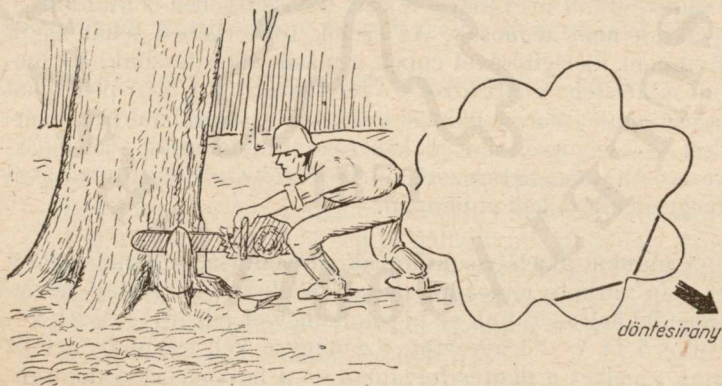
22. ábra. A fa döntési irányra felőli oldalán levő terpeszeket döntés előtt el kell távolítani
