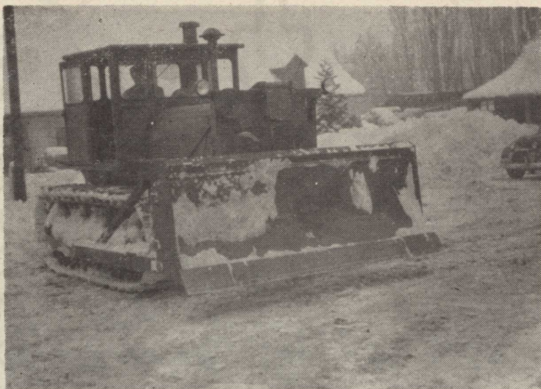
A legújabb Sz-100-as traktort műhelydolgozóink felszerelték tolólemezzel. Ez jó szolgálatot tesz télen a hóakadályok megszüntetésében, de kiváló eszköz a talajmunkáknál is
