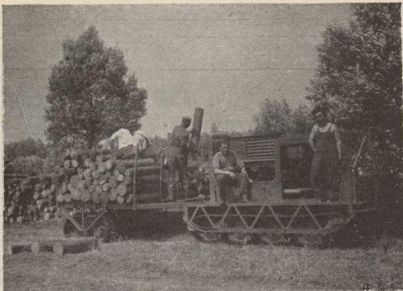
A „ROLBA” gumiláncalpas traktor láncalpas pótkocsijával van hivatva a más járművek számára már járhatatlan hanyi talajon a famozgatást elvégezni
