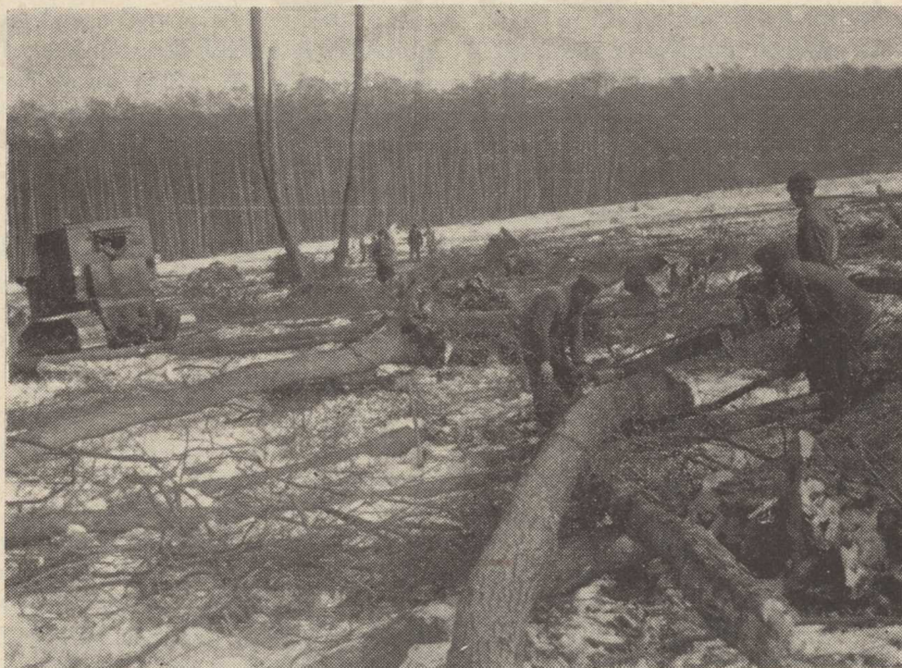
A Dél Hanság-i erdészet éger véghasználati termelésében a kiközelítés elvégzéséhez megjelent a vágásterületen az Sz-100-as is, és pótolja a fogaterőt. A szálfaban való kiközelítés után a felkészítés közbenső rakodón történik
