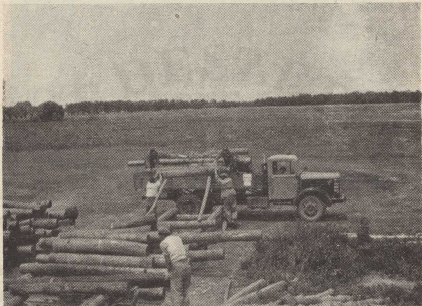
A „Csepel” 3.5 tonnás teherautók a legjobban bevált szállító járműveink. Feladatuk a közbelső rakodóról a feladóállomásra vagy a vevők telepére szállítani a faanyagot
