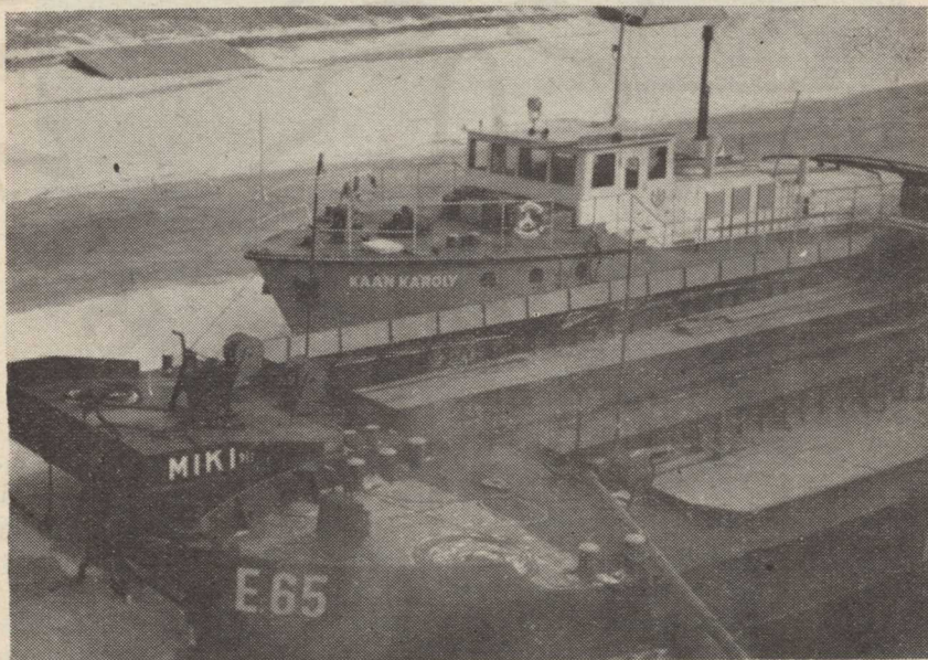
A nagy kiterjedésű Dunaártér ágvizsein a faanyagmozgatási feladatainkat jelentősen megkönnyítik saját hajóink. A „Kaán Károly” 125 lóerős vontató, a MIKI, az E-64, E-65 sz. 6-6 vagonos uszályok a győri termál-víz kifolyásánál jégnyomás veszélye nélkül teletnek és várják a tavaszi uszályozás megindulását.
