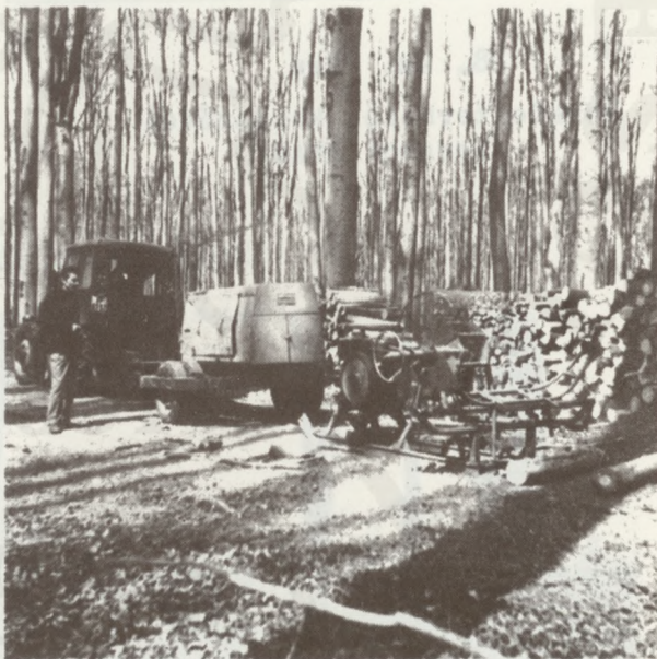
17. sz. ábra Hasító és kérgezógép erdei felkészítő rakodón /Borsodi EFAG/
