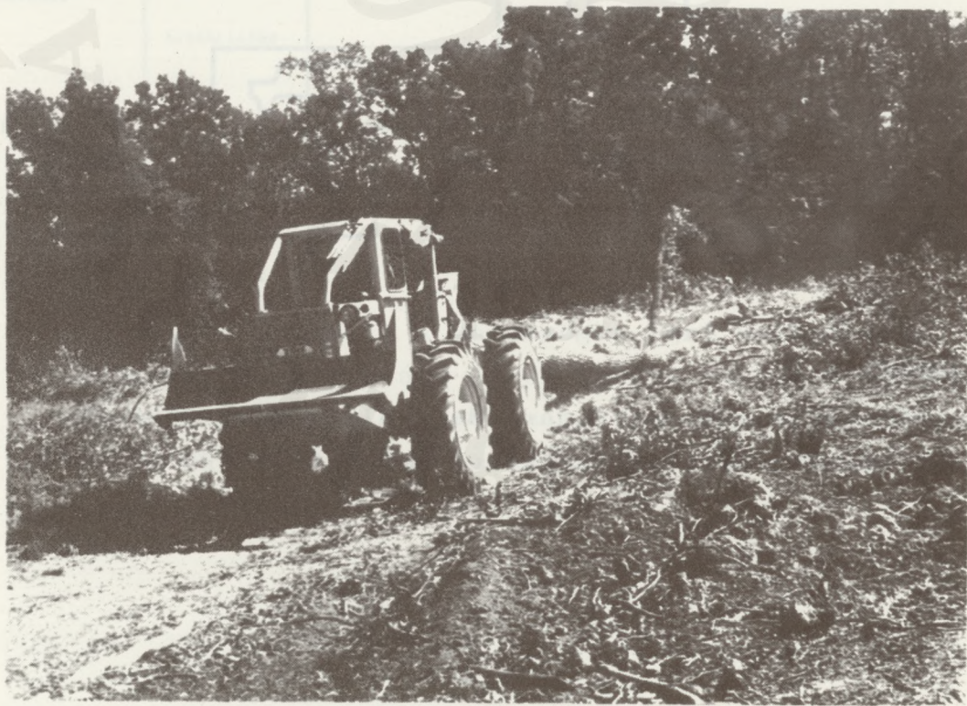
19. sz. ábra LKT-75-ös traktor hosszufa vonszolásban
