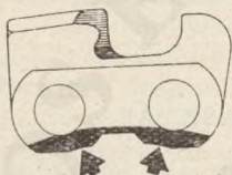
76. ábra. a) az élesítési szög több 55–60 foknál, b) az élesítési szög kisebb 50 foknál
