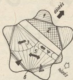
99. ábra. Döntés a húzástól számítva oldalra a terpeszek felhasználásával és aláékeléssel
