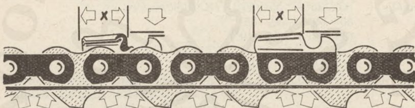
43. ábra. A gyalufogas fűrészláncok élesítésének egyik legfontosabb kritériuma: a fogak egyenlő hosszúsága
