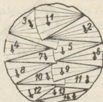
104. ábra. Darabolás egyszemélyes motorfűrészrel, a faátmérő a vezetőlemez hosszának 1—2-szerese
