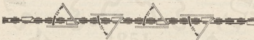
43. ábra. A gyalufogas fűrészláncok élesítésének egyik legfontosabb kritériuma: a fogak egyenlő hosszúsága
