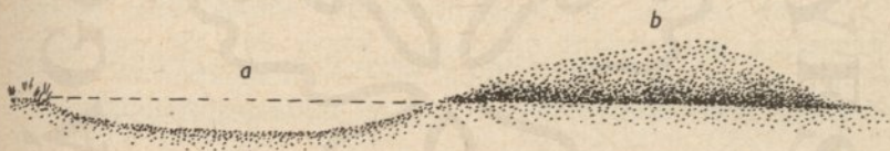
39. ábra. A szél homokszállító hatása a) elhordás vagy defláció, b) akkumuláció vagy felhalmozódás
