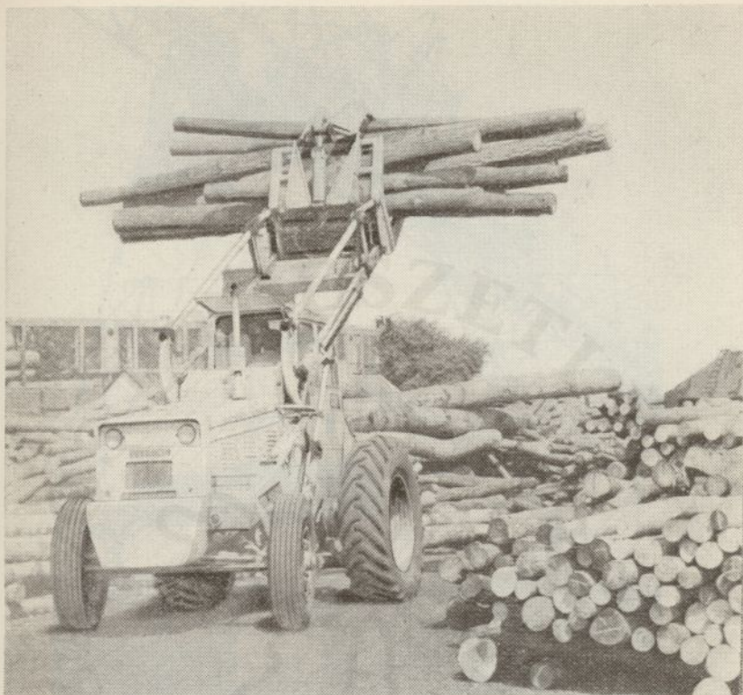
2. ábra. VOLVO homlokmarkolós anyagmozgató-, rakodó gép (Kovanecz F. felv.)
