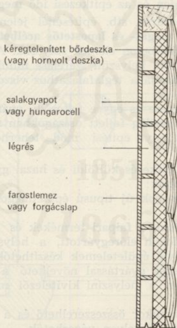
95. ábra. ERDÉRT-típusú hőszigetelt, szendvics-panelszerkezet metszete
