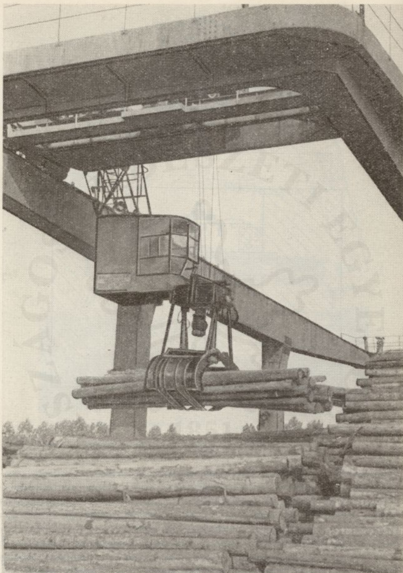
5. ábra. Fűrészrönk belső mozgatása, máglyázása konzolos bakdaruval. (Kovanecz F. felv.)
