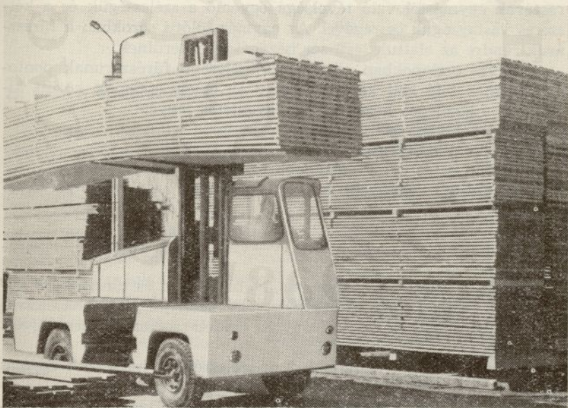
24. ábra. Fűrészáru telepen belüli mozgatása oldalvillás targoncával. (Kovanecz F. felv.)
