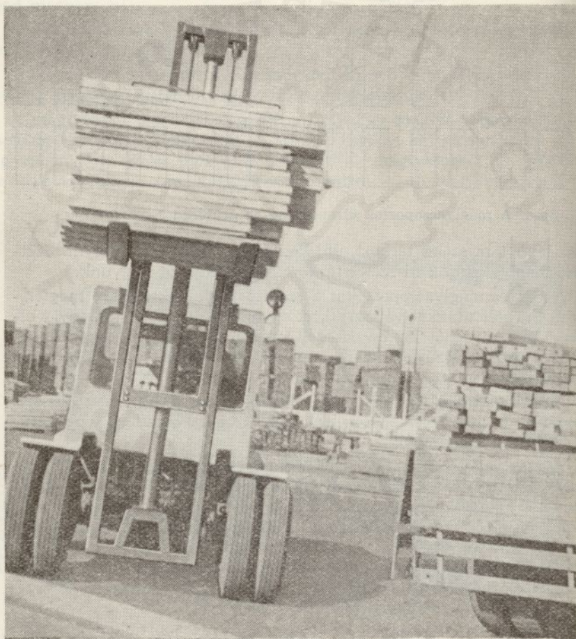
28. ábra. Fűrészáru rakodás homlokvillás targoncával. (Kovanecz F. felv.)
