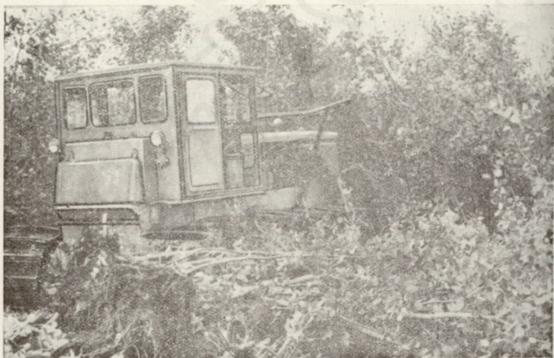
32. ábra. Fakitermelés tolólemezes géppel
