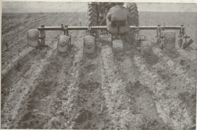
12. ábra. Víztároló töltőgető felszerelés
