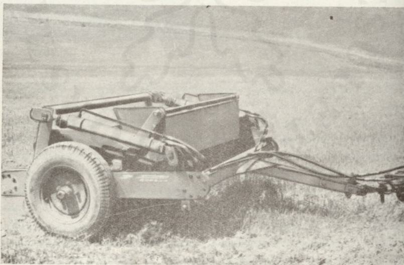
28. ábra. Talajgyalu földkitermelés közben
