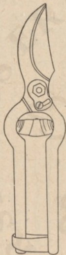
9. ábra. 124 típusú egyélű metszőolló
