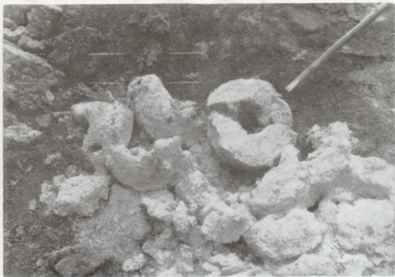
10. kép. Mélyfúrással áttörtük a vízzáró réteget. A fényképen a kikerült anyag kemény, kőszerű darabjai láthatók.
