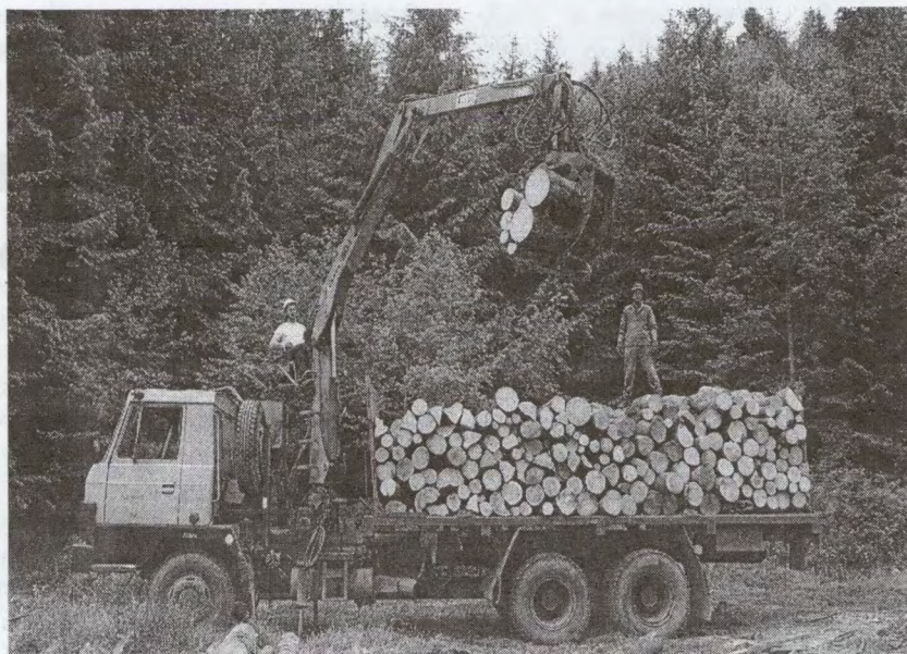
ESSEL 80.1 típusú szlovák gyártmányú hidraulikus markolódaru (Cég-fotó)
