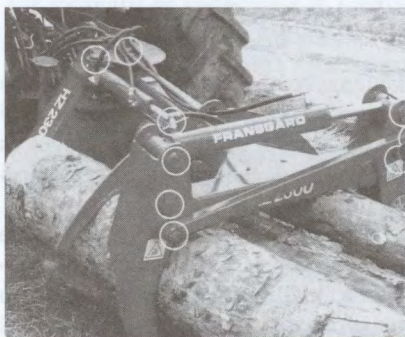
A dán Fransgård közelítő markoló csuklópontjaiba nagy teherbírású bronzperselyeket építettek. A rakomány megmarkolása stabil, rögzített.
