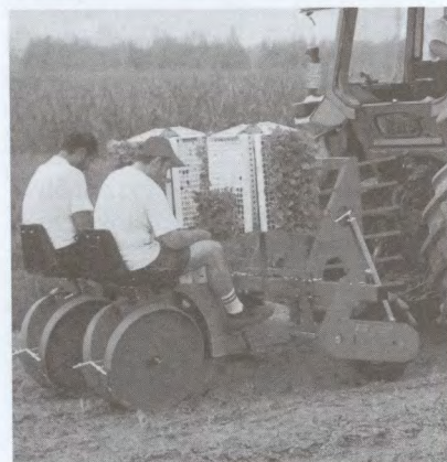
A Ferrari „F max” ültetőgép 2-6 üléses változatban készül
