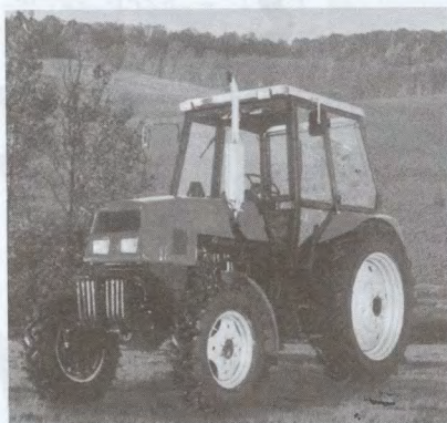
LTZ-60 AB Tornado típusú orosz traktor. Négyütemű motorja 70 LE-s, négyhengeres, vízhűtéses Diesel. Ára 2,6 millió Ft + ÁFA
