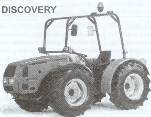
Az olasz Valpadana-gyártmányú „Discovery” traktor 12+12-es váltóműve összesen 72 sebességfokozat beállítását teszi
