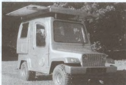
Az ElectroAuto Kft. által gyártott terepjáró gépkocsi, a tetőcsomagtartó helyén vízszintes ki- és betolható fotovoltaikus napelem-panellel
