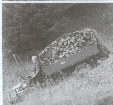
A Carraro „Tigrecar 3200” tip. szállító-jármű egy kistraktor és egy billenőplatós terepjáró teherautó tulajdonságait egyesíti, s családi mező- és erdőgazdaságok többcélú gépe lehet.
