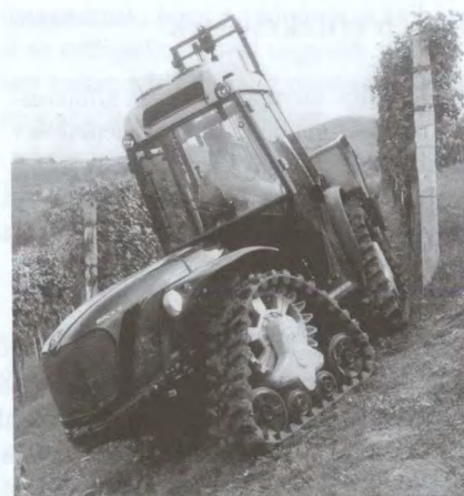
Az Antonio Carraro olasz gépgyár „Mach 4” tip. kistraktora zárt, klimatizált vezetőfülkével szerelve, szőlőmunkában tolómenetben. A képen jól szemügyre vehető a speciális gumihernyótalpas futómű a meghajtókerékkel és a feszítő-futógörgőkkel.
