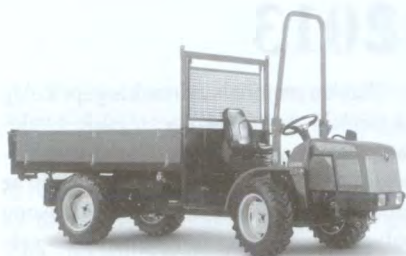
A Carraro „Tigrecar 3200” tip. szállító-jármű egy kistraktor és egy billenőplatós terepjáró teherautó tulajdonságait egyesíti, s családi mező- és erdőgazdaságok többcélú gépe lehet.
