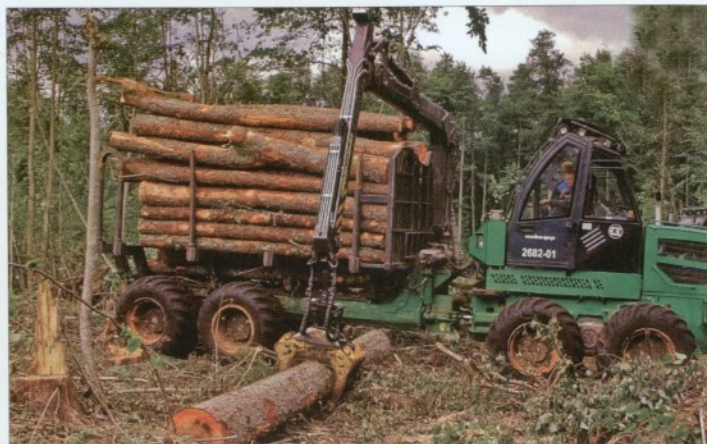
A belorusz gyártmányú Amkodor forwarderén jól megfigyelhető a vezetőfülke kialakítása, a hátsó ablak jó rálátást lehetővé tevő íveltsége
