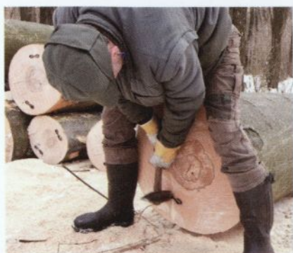
Sasi László hosszol „S” kapcsolót ver a rönk repedésének megakadályozására
