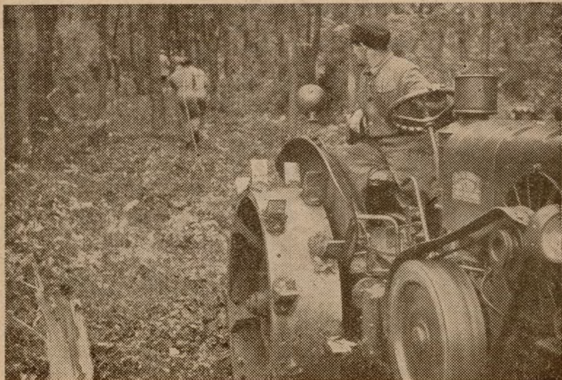
A traktor beállt, odaviszik a drótkötelet a kidöntendő fához
