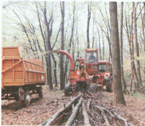
Helyszíni aprítéktermelés Fotó: ERTI
