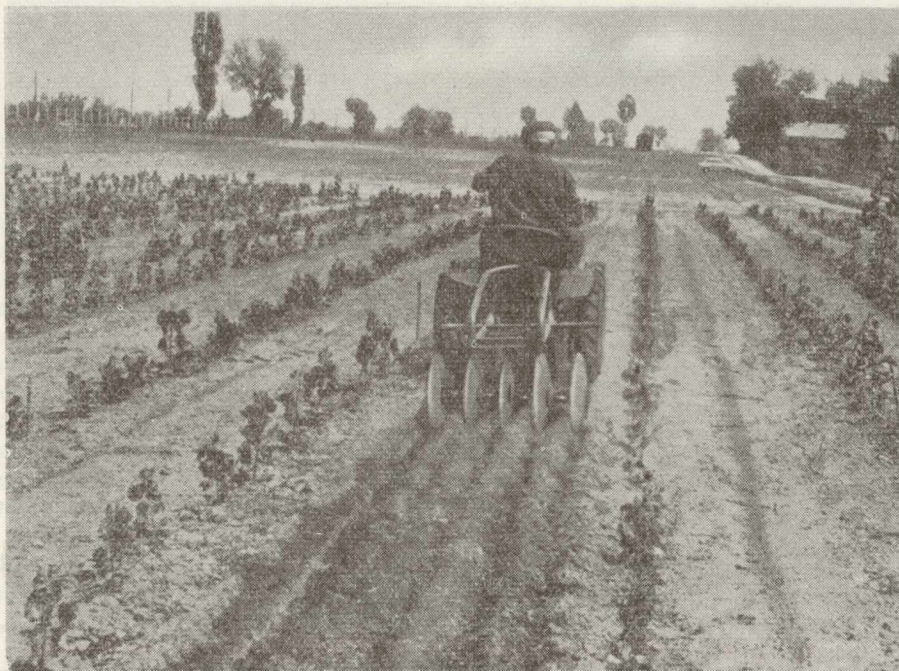
4. ábra. A T4K-12 kistraktor FT-100 tárcsás kultivátorral
