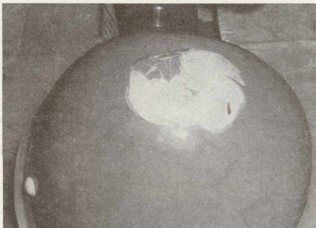
2. ábra. Az üvegszövetes poliszter sisak tönkremenetele
