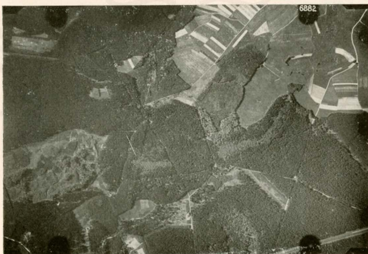
Erdőgazdasági térkép készítéséhez stereo-felvétel repülőgépről. A felvétel mintegy 2500 m magasságból történt.
