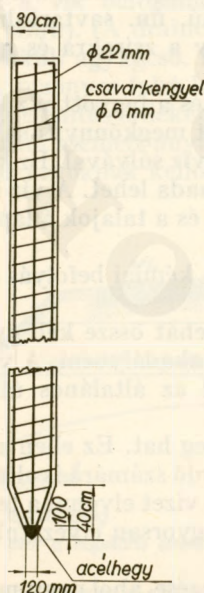
2.62-63. ábra. Vasbeton cölöp
