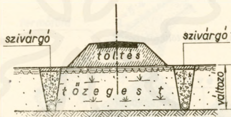
2.61-14. ábra. Altalaj kiszárítása töltés alatt
