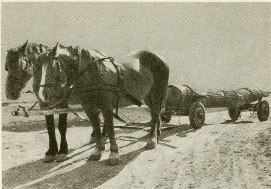
2.21-5. ábra. Hradeci kerékpár. Csehszlovák gyártmány. Súlyja: 102 kp. Teherbírása: 1,5 m 3 . Tömör gumikerék magassága: 51 cm
