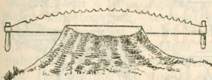
46. ábra. A fűrész befogása a visszahagyott tuskóba
