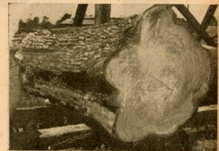
Ami helytelen a délfűrészek barcsi üzemében. A vagonkikrakó daru alatti térség telítve van rendkívül nagy átmérőjű úgynevezett bühöncfával, pedig ezeket a Brenta-fűrész folyamatosan vágatná, s akkor éppen a daru alatt terítve lehetne a gömbfát átvenni
