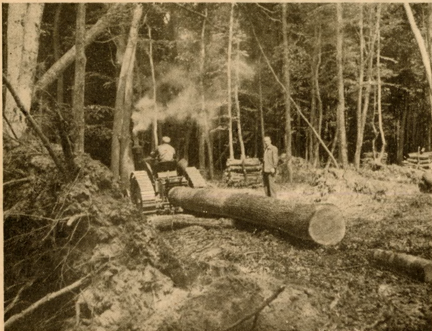
Lánctalpas vontató szállítja ki kövesútra az elpusztult erdőrészből a ledöntött fákból kiszabott rönköket
