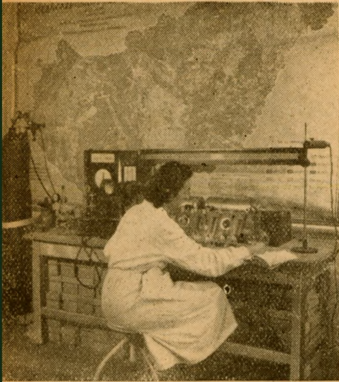
Horváth Endréné tudományos segéd- munkatárs Láng-fotóméterrel kálium és nátrium meghatározást végez
