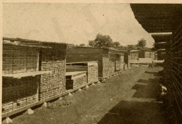
Szakszerűen máglyázott, gondosan lefedett fűrészáru
