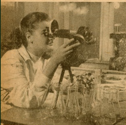
Tatár Sándorné laboráns fotóméterrel végzi a foszfor meghatározását
