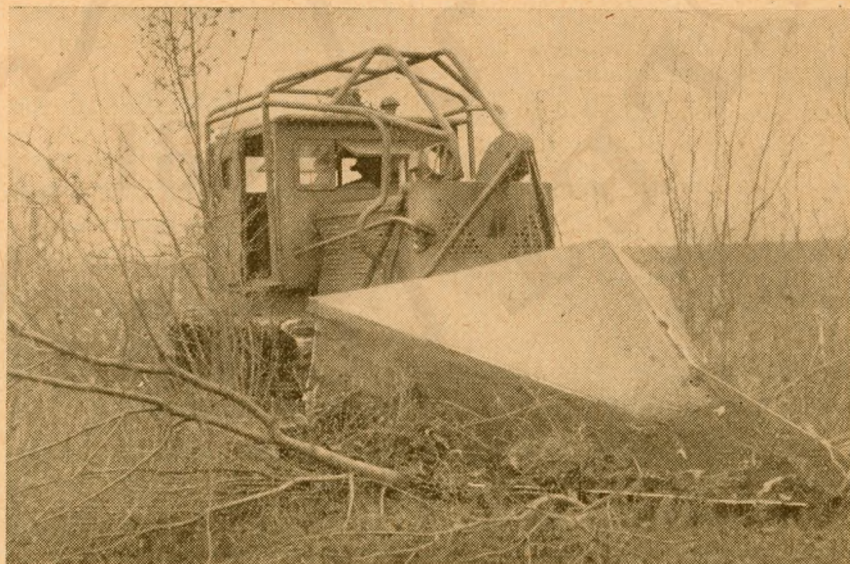
Érdekes, új erdőgazdasági gépet gyárt a kazányi gépgyár. Az új gépet cserjetisztítónak nevezik s a tapasztalatok szerint 18 cm-nél vastagabb fákat is elmozdít útjából. A cserjés, fás területeket alkalmassá teszi újraerdősítésre, vagy mezőgazdasági művelésre.
