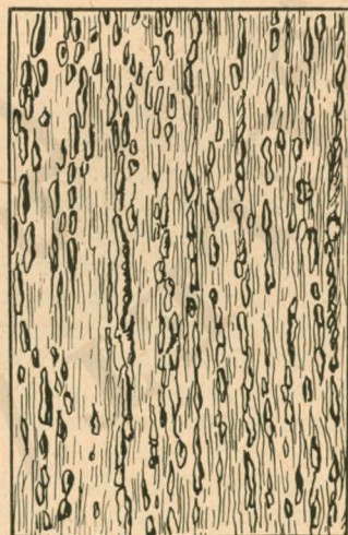
60. ábra. A tölgy fehérrevesedése. A fogoly fehér-barna tarka színű tollazatához hasonlít a megtámadott fa
