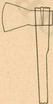
90. ábra. A fejsze nyelének ékelése a kónikus lyukban
