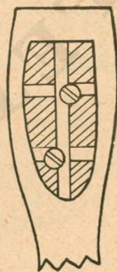
92. ábra. A faék rögzítése facsavarral a fejszenyelhez
