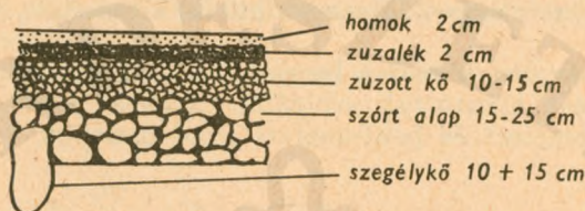
158. ábra. Szórt alapú kőpályás út szelvénye
