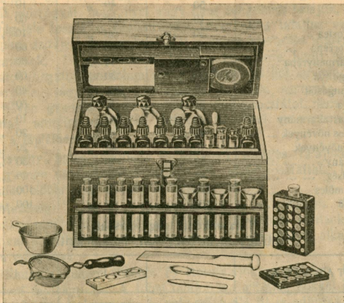
20. ábra. Helyszíni talajvizsgálókészülék. Ilyen az agronómus hordozható talajlaboratóriuma
