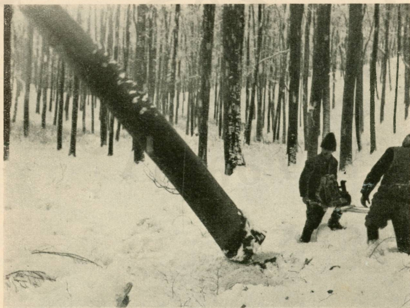
27. ábra. Döntőfűrészelés motorfűrészsel
