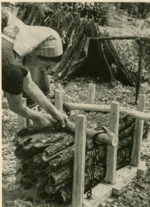
42. ábra. Cserkéreg kötözése géppel
