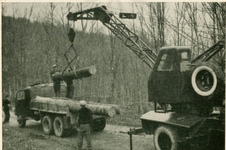
Az 5—16 mázsás rönköket játszi könnyedséggel emeli a gépkocsikra a Janvarec-típusú szovjet autódaru: 6 ember 3 órai munkáját 20 perc alatt végzi
