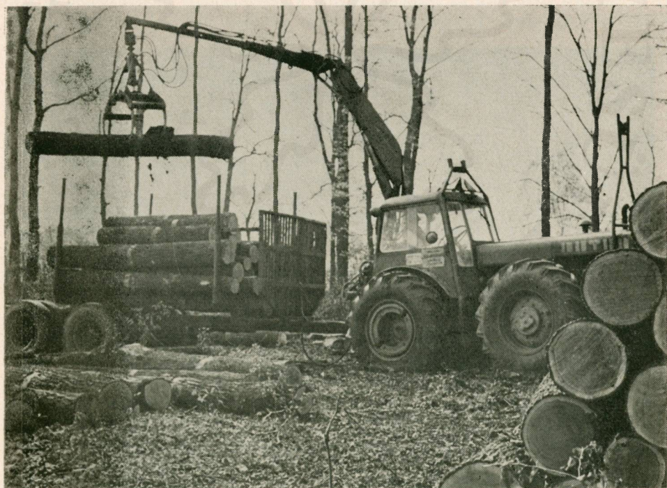
D 4 K B vontatóra szerelt HIAB 173 típusú (svéd) hidraulikus daru az erdőgazdaságnál gyártott 10 tonnás utánfutóra rönkök terhel fel.
