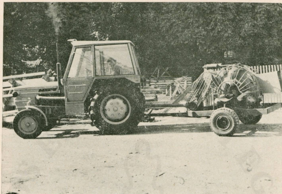
A CAMBIO (svéd gyártmány) kérgezőgép munkában.
