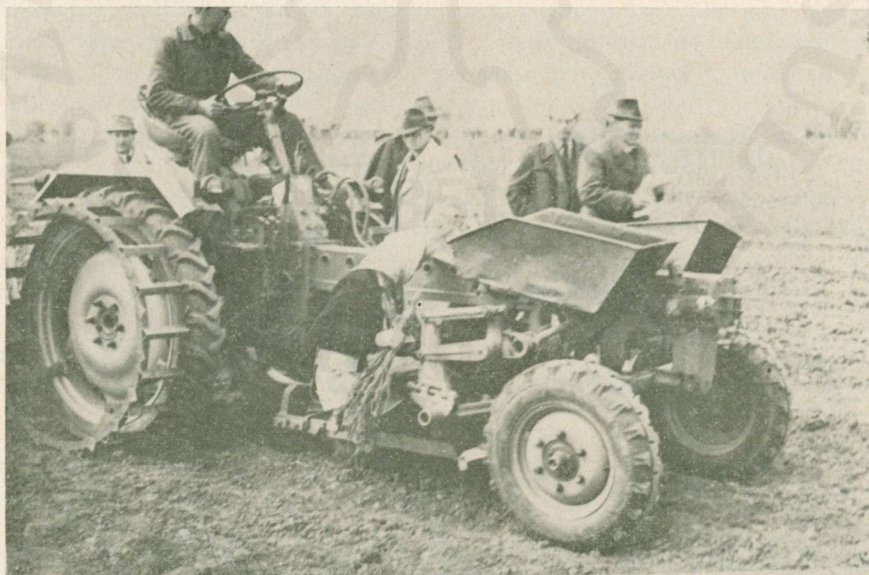
Gépi csemeteültetés Maulwurf eszközhordozóra szerelt csemeteültető berendezéssel.
