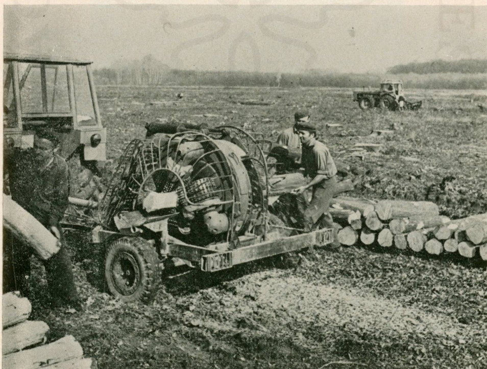
A CAMBIO (svéd gyártmány) kérgezőgép munkában.
