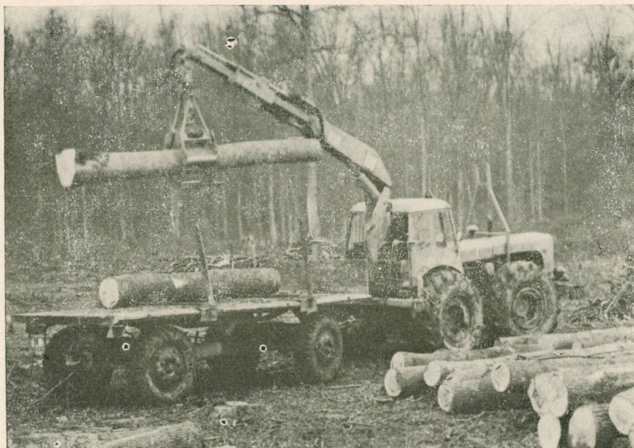
D 4 K B traktor pótkocsival, HIAB (svéd) 173 típusú hidraulikus „erdei elefánt” daruval rönkfeltételés közben.
