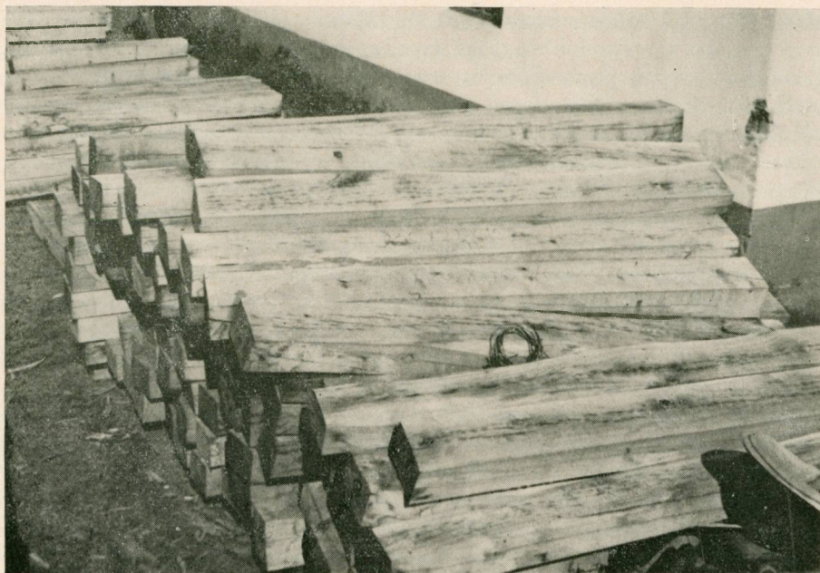
Sok ezer iparvasúti talpfa készül a bányavasutak és a gazdasági vasutak számára.
